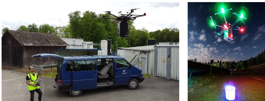
Fig. 1: Links: LUCS-System kurz nach dem Start vor dem Transporter (mobile Bodenstation). Rechts: Aufnahme vom LUCS-System in der Abenddämmerung während einer Messkampagne auf der Laserfreistrahlsstrecke am DLR Lampoldshausen.
