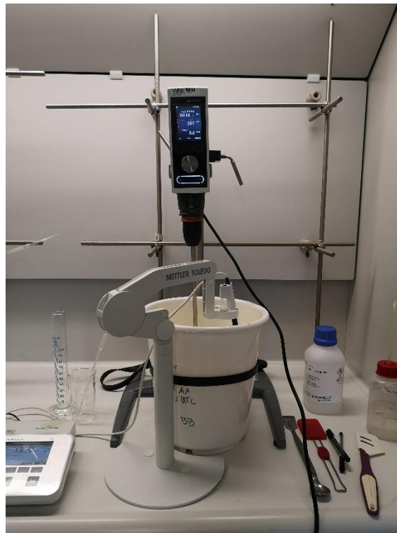
Abb. A 4 Aufbau der Neutralisation der Beads unter kontinuierlichem Rühren und Zugabe von Essigsäure.
