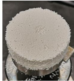
Abb. A 14 Probe A um 50% komprimiert, Nr. 1.
