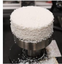
Abb. A 15 Probe A um 50% komprimiert, Nr. 2.
