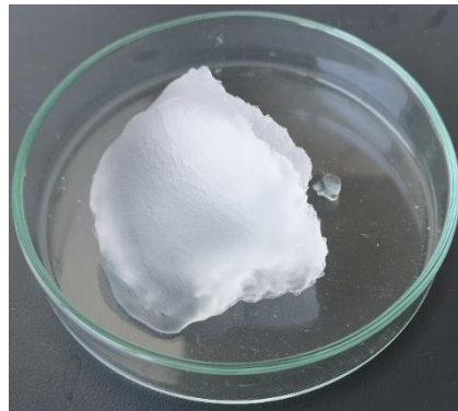
Abb. 2-3 Cabot P300, das mit dem Ultra Turrax in Ethanol für 10 min bei 10.000 U/min zerkleinert wurde.
