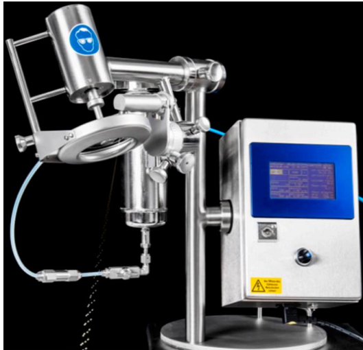
Abb. 1-7 JetCutter der Firma geniaLab® zur Produktion von polysaccharidbasierter Gel-Beads. [26]
