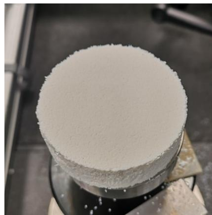
Abb. 3-20 Beispiel für einen intakten Formkörper; Hier: Probe C wurde um 75 % komprimiert.
