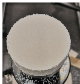
Abb. A 24 Probe B um 75% komprimiert, Nr. 1.
