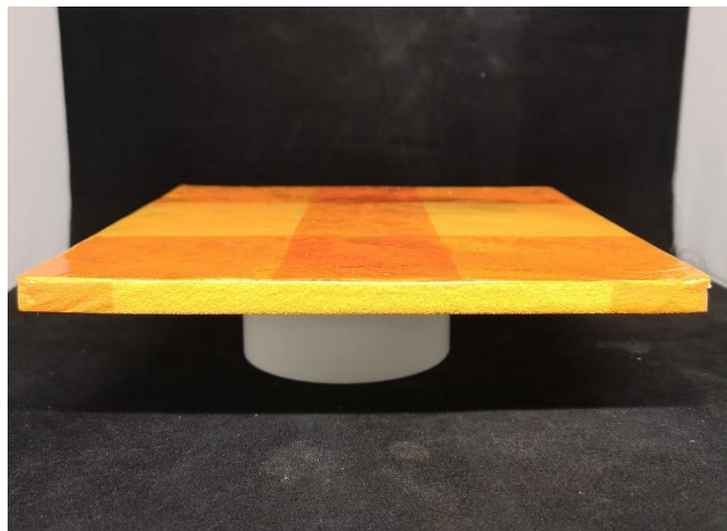
Abb. 3-23 Erfolgreiches Herstellen einer Platte aus Aerogel-Beads, die um 50 % komprimiert wurden. Die komprimierten Beads wurden in einer Bügelfolie eingeschlossen.
