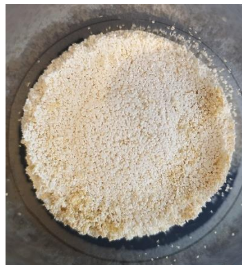
Abb. 3-25 Beispiel für lokale Überladungen mit Haftvermittler
