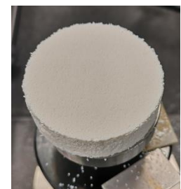
Abb. A 27 Probe C um 75% komprimiert, Nr. 2.
