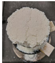
Abb. A 18 Probe C um 50% komprimiert, Nr. 1.
