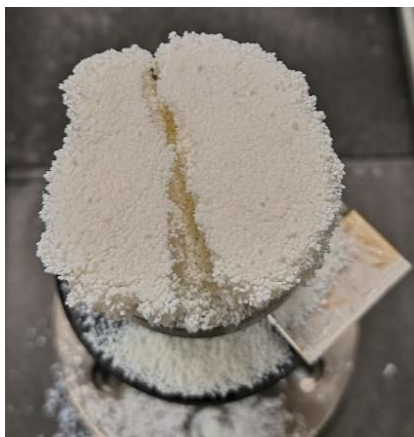
Abb. 3-19 Beispiel eines zerbrochenen Formkörper; Hier: Probe C wurde um 50 % komprimiert.
