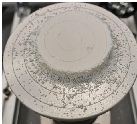
Abb. 3-21 Probe C 75 % komprimiert; Während des Druckversuches sind einige Beads abgeplatzt. Nach weiterer Beanspruchung wurde der Formkörper weiter verdichtet.
