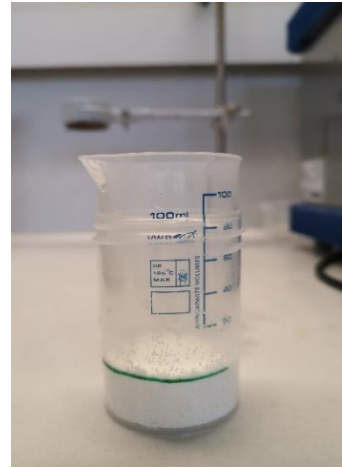
Abb. 2-11 Kompression der beschichteten Beads bis zu einer Endhöhe von 2 cm.
