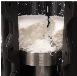
Abb. A 16 Probe B um 50% komprimiert, Nr. 1.
