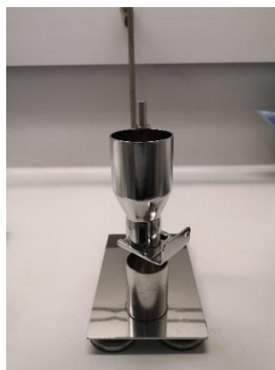
Abb. 2-12 Apparatur zur Bestimmung der Schüttdichte gemäß DIN /EN ISO 60.
