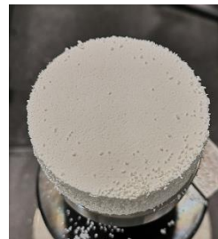
Abb. A 22 Probe A um 75% komprimiert, Nr. 1.
