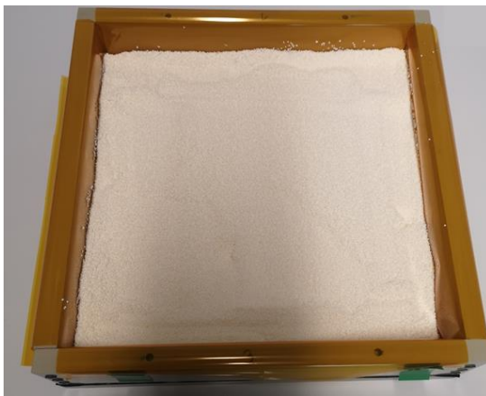
Abb. 2-8 Rahmen zur Kompression zu einer Höhe von 2 cm mit Aerogel-Beads gefüllt.
