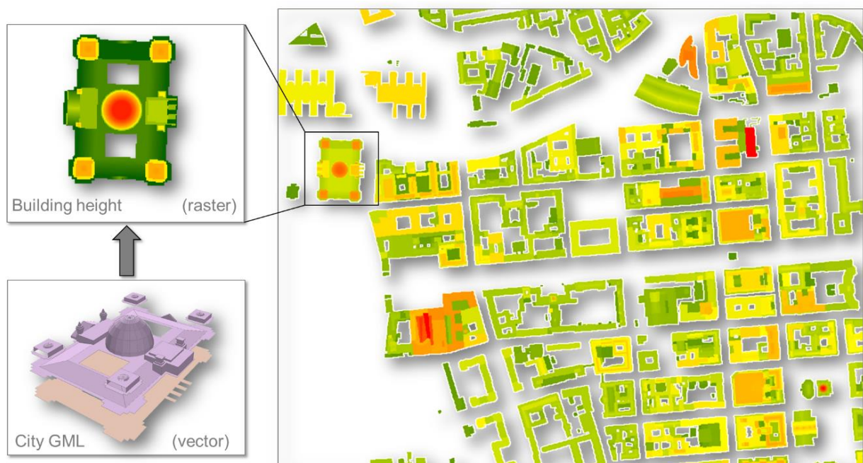
Abbildung 2: 3D Gebäudedaten im Rasterformat und als Vektormodell (City GML) mit der Detailstufe LoD2.
