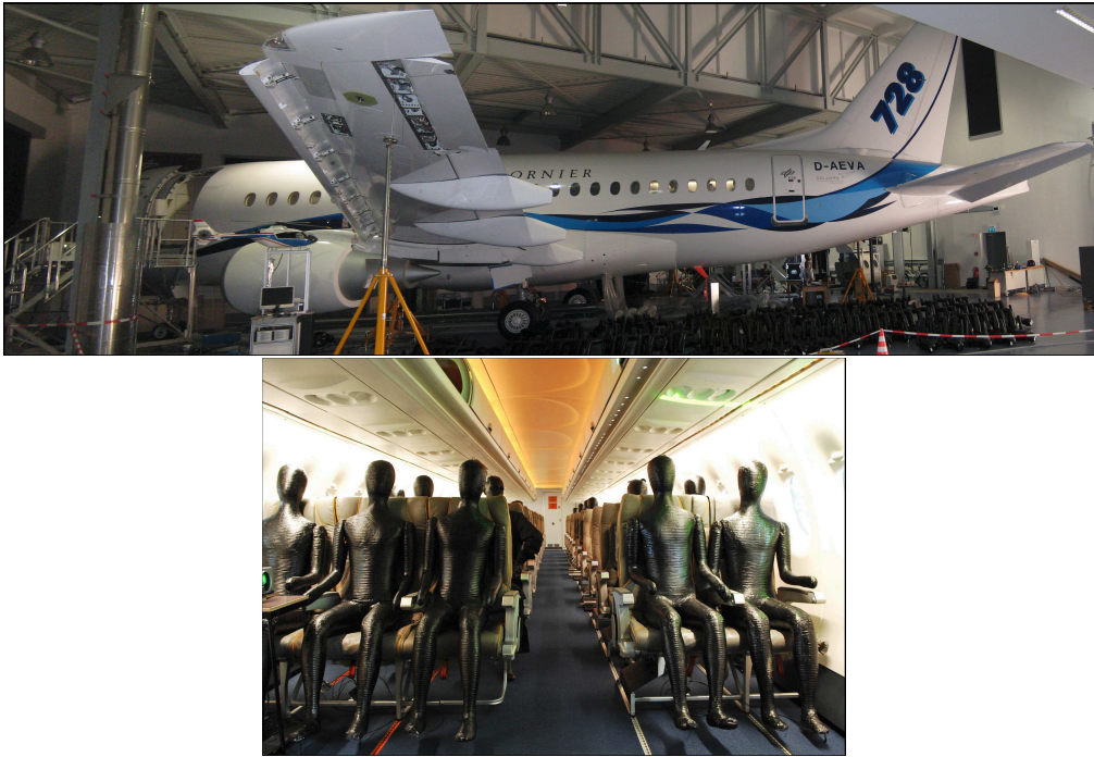
Abb. 1.1: Kabinen-Testanlage für Kabinenklimatisierung am DLR Göttingen. Oben: Außenansicht des Versuchsträgers Dornier 728. Unten: Innenansicht der Flugzeugkabine mit Dummies in Vorbereitung auf ein Experiment.
