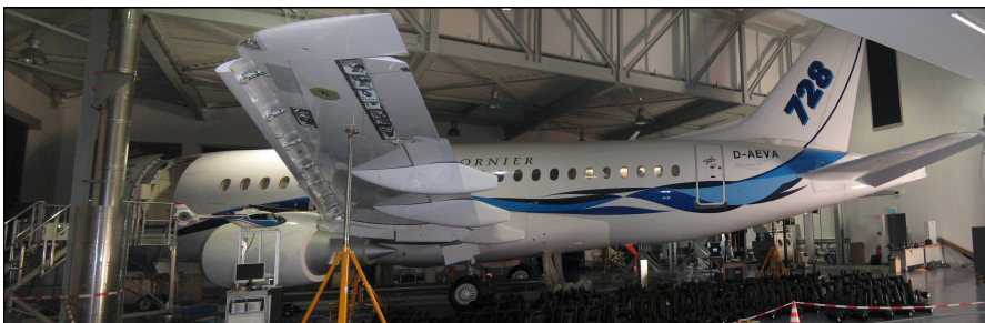
Abb. 4.1: Versuchsträger Passagierflugzeug Dornier 728 zur Erforschung neuer Klimatisierungskonzepte am DLR Göttingen.
