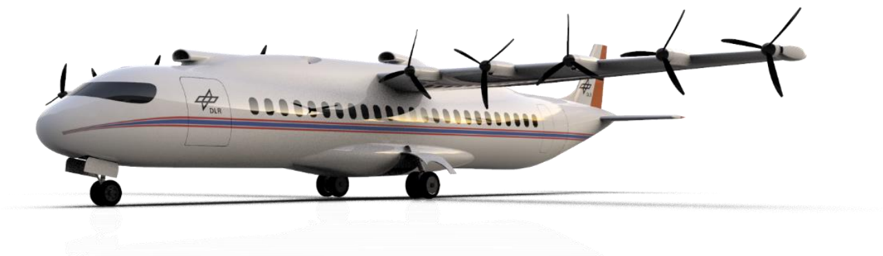
Abbildung 1: Darstellung des finalen Flugzeugentwurfs mit verteilten Antrieben.
