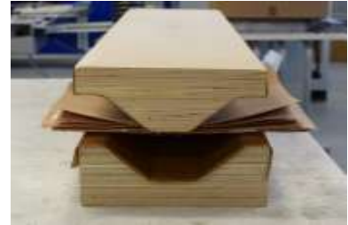
Ablage des Furnierstapels in die Hutprofilform
