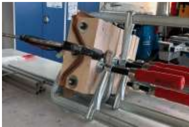
Verpressen und Aushärten/Konsolidieren (24 h) der Hutprofile
