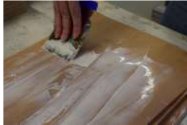
Auftragen des Klebstoffs auf die Furnierlagen
