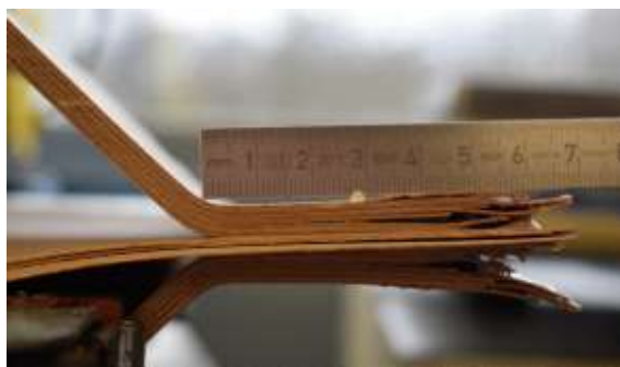
Abbildung 28: Delamination der Seitenflächen
