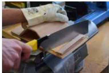
Kürzen der Verbindungsfläche auf 30 mm
