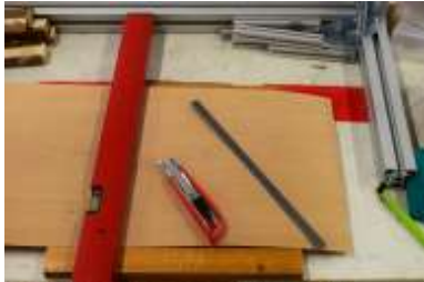
Zuschneiden der Furnierlagen entsprechend des Versuchsplanes
