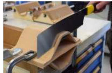
Ablängen und Zuschneiden beider Seitenflächen auf 120 mm
