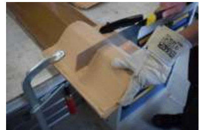
Halbieren der Hutprofile mit Hilfe einer Japansäge
