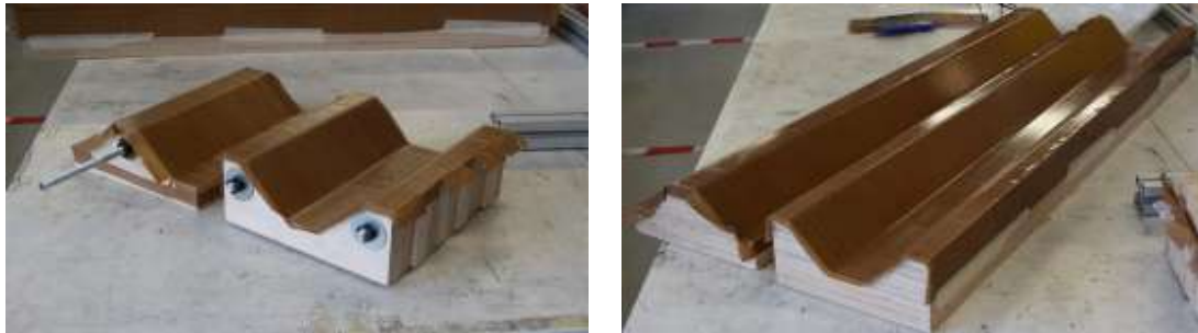
Abbildung 18: Werkzeug zum Formpressen der Hutprofile
