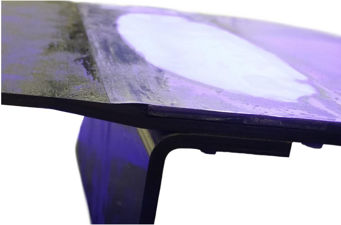
Abbildung 26: Spalt der Vorspannungskompensation bei -10^{\circ}\text{C}
