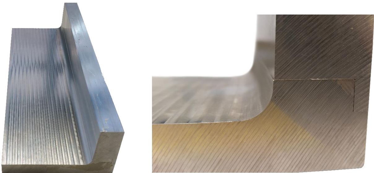
Abbildung 9: zweigeteilte Bauweise des Frontsparwerkzeugs
