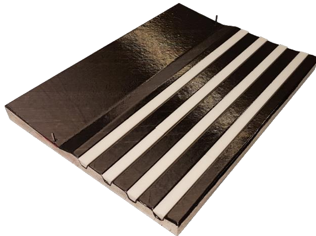
Abbildung 11: Leading Edge mit Prepreg und Schaumeinlegestücken
