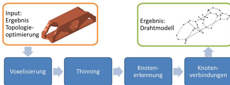
Bild 5: Automatisierte Prozesskette der Skelettableitung aus Topologieoptimierungsergebnissen
