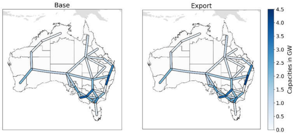
Abbildung 2-30: Endogener Zubau des Stromnetzes (>100 MW) im Basisszenario (links) sowie der Variante "Export" (rechts).
