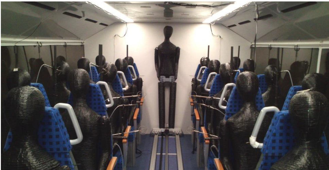
(c) Foto des generischen Zugabteils inklusive der Traverse und des Dummies im Gang.
