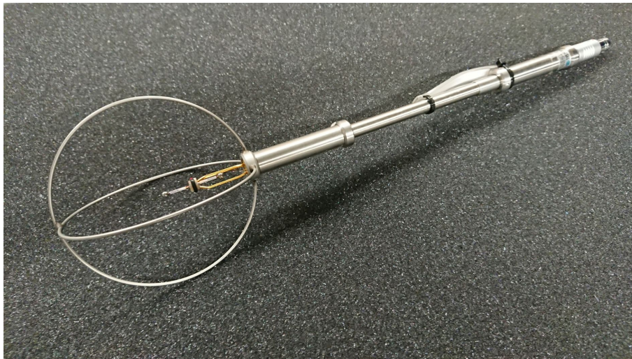
Abb. 3.6: ComfortSense -Sonden der Firma Dantec Dynamics für simultane Temperatur- und omnidirektionale Geschwindigkeitsmessung mit Schutzgitter.
