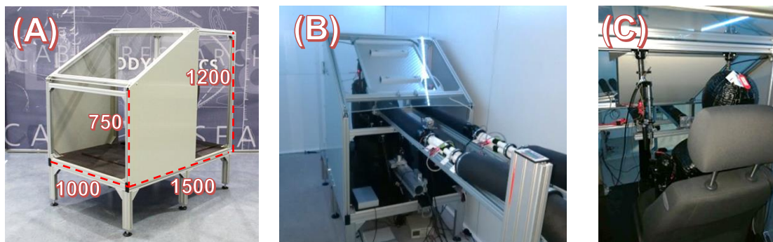
Abbildung 1: (A) Foto der SPC mit Maßangaben in mm. (B) SPC mit Luftzuführung und Volumenstrommessstrecken. (C) Rückansicht des TMs mit Lufteinlässen.
