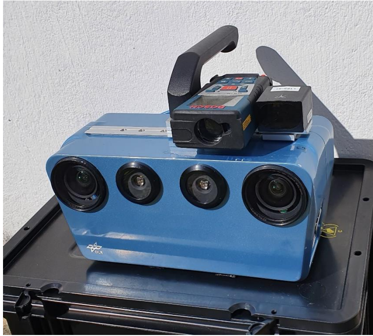
Abbildung 4.1: IPS Sensorkopf mit Laserscanner
