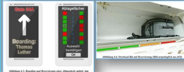
Abbildung 6.5: Boarding und Reservierung eines Ablagefachs mittels App
