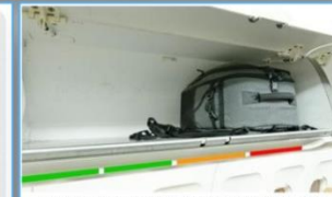
Abbildung 6.6: Overhead-Bin mit Reservierung (Bild ursprünglich aus [45])
