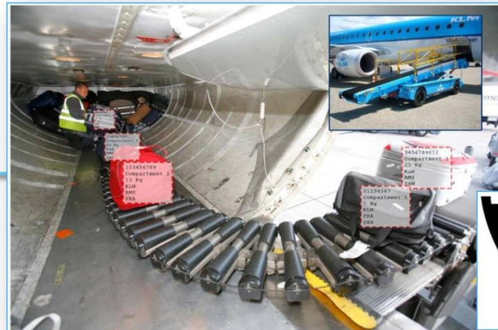
Abbildung 6.8: Vorstellung von Augmented Reality im Frachtraum (Bild ursprünglich aus [47])
