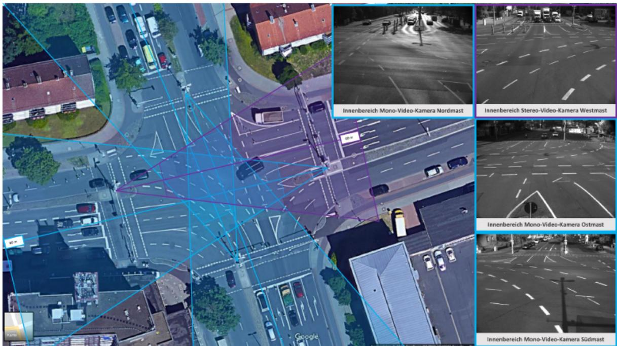
Abbildung 1: „Sichtbereiche der Sensor-Systeme zur 3D-Merkmalberechnung im Innenbereich der Kreuzung.“ [Arn18, S. 96]
