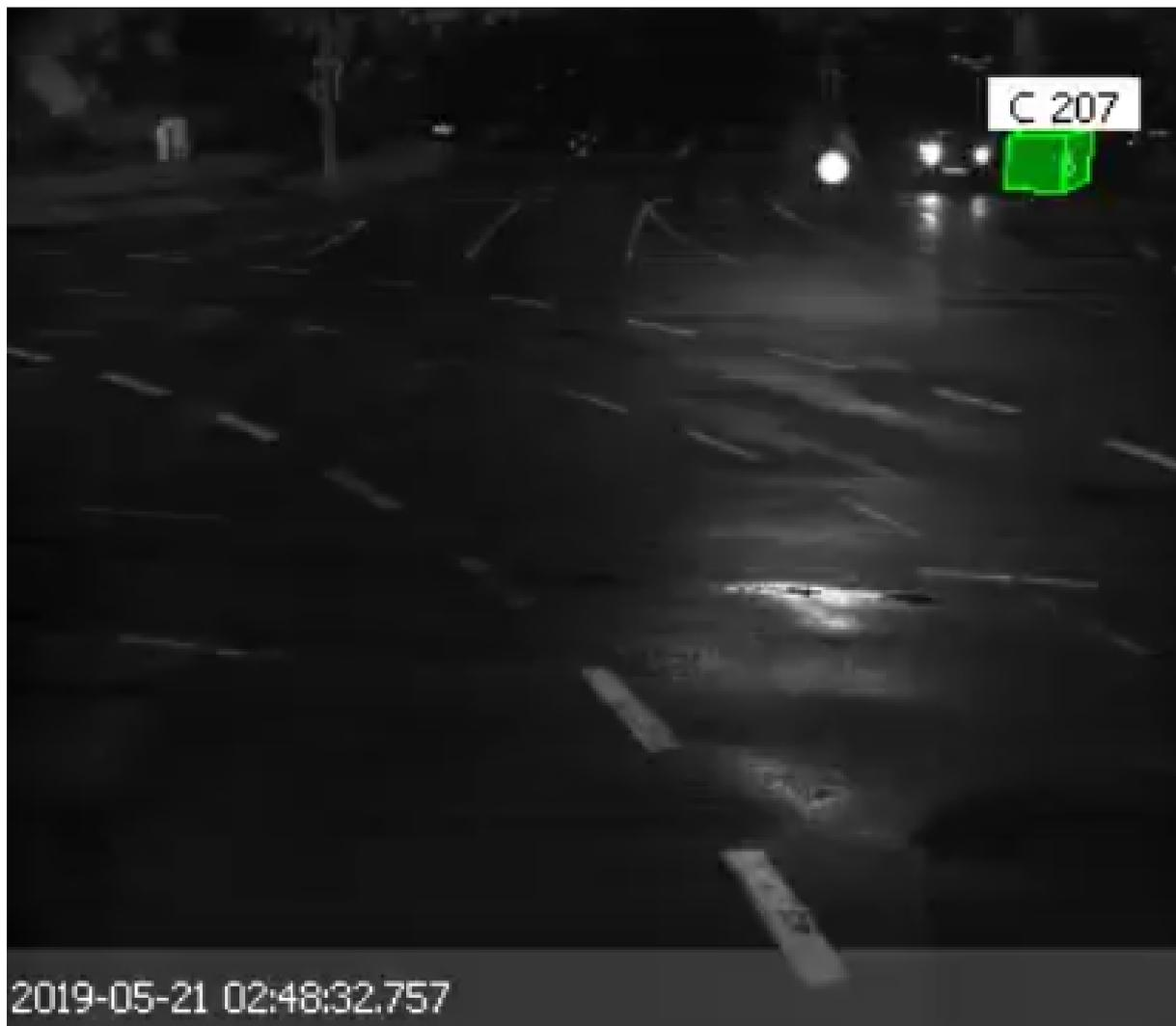
Abbildung 24: Videobild der Kamera, die im Süden auf den Innenbereich der Kreuzung nach Norden ausgerichtet ist. Der Verkehrsteilnehmer C 207 wird nach der Bewegungsrichtung in diesem Videobild als Anomalie klassifiziert, da für dieses Fahrzeug aufgrund einer fehlerhaften Positionsbestimmung eine Abweichung von der an dieser Position üblichen Bewegungsrichtung detektiert wurde.
