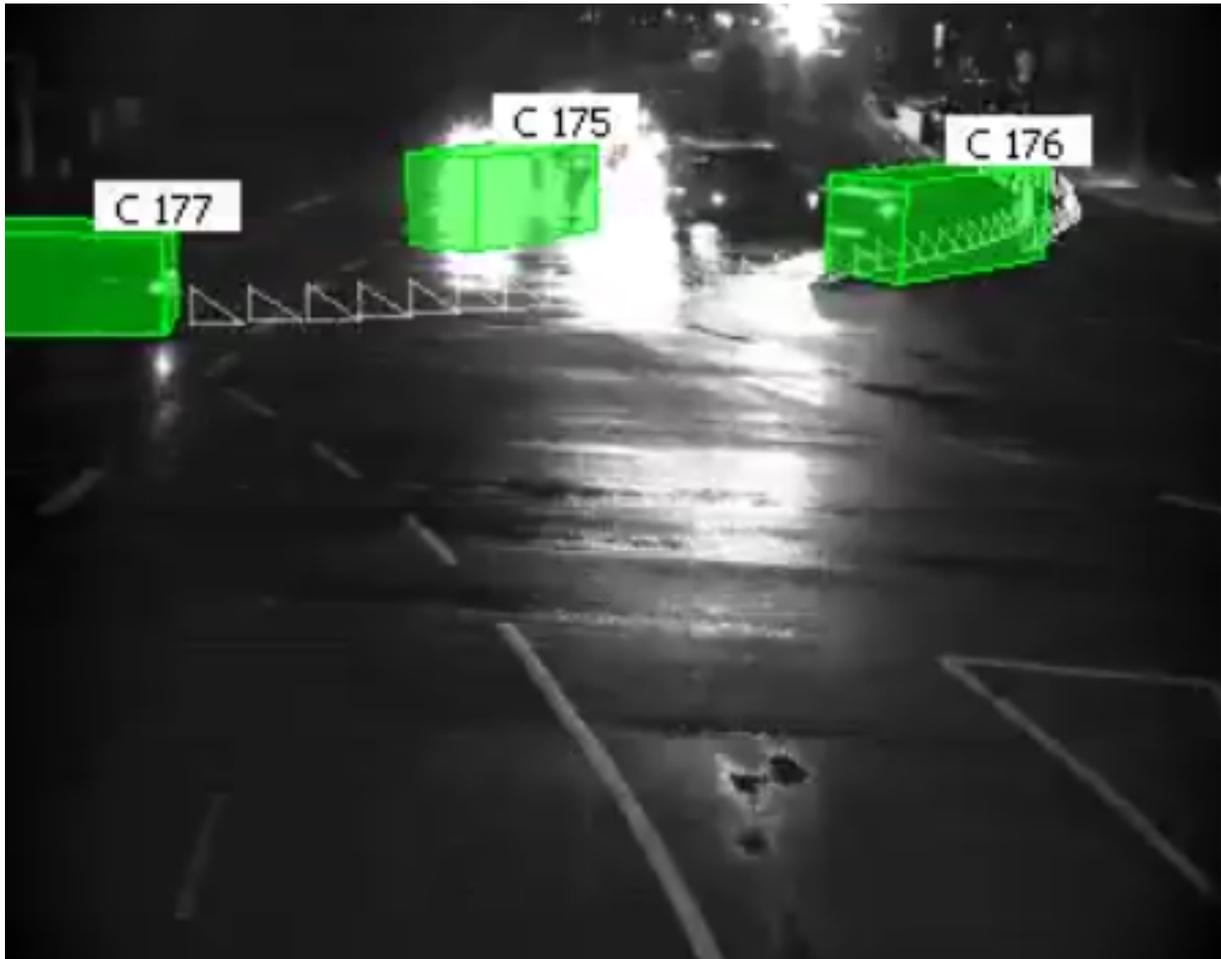
Abbildung 10: Anomalie Objekt C 175 (grün): Die Trajektorie des Objektes schneidet zwei Polygone, die sich an einer Einfahrt der Kreuzung befinden. Dies ist darauf zurückzuführen, dass die Position eines Objektes fehlerhafte bestimmt wird.
