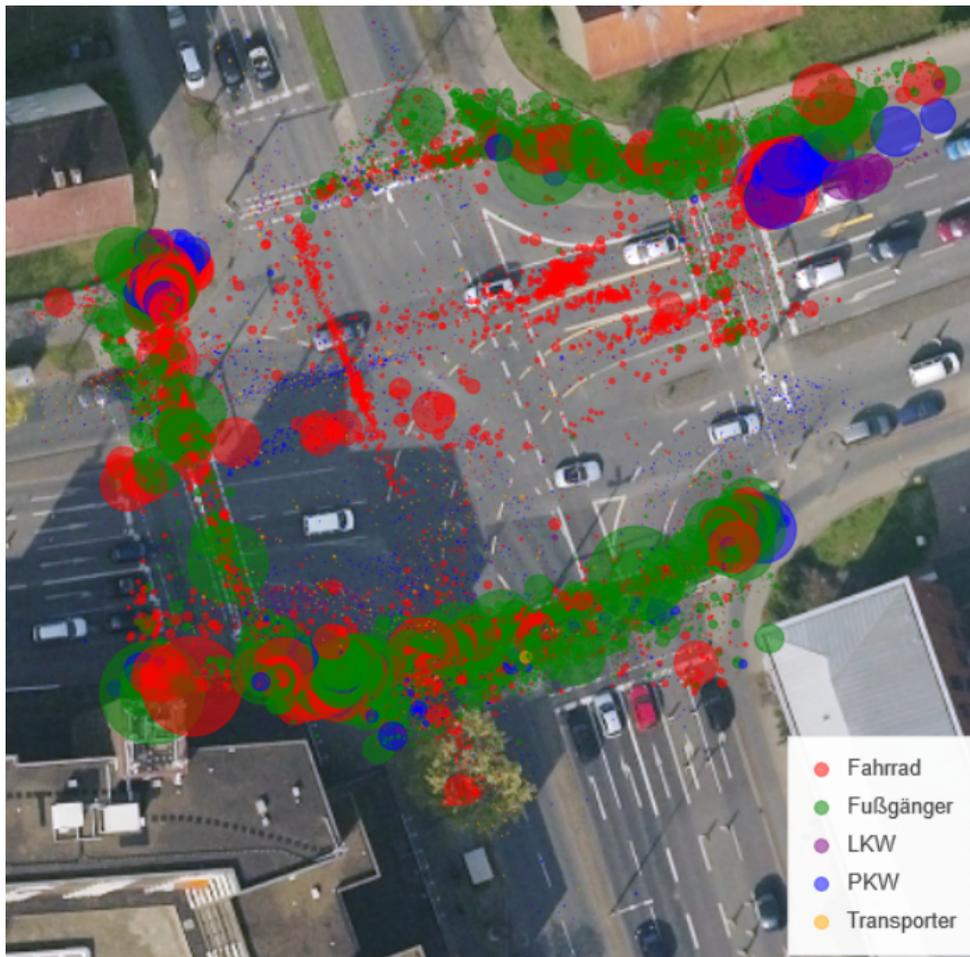
Abbildung 3.3: Datenpunkte mit fehlerhafter Differenz der digitalen Zeitstempel auf der Fokr. Die Größe des Kreises gibt die Differenz der digitalen Zeitstempel an. Der kleinste Kreis entspricht einer Differenz von 0,08 s und der größte Kreis einer Differenz von 62 s.
