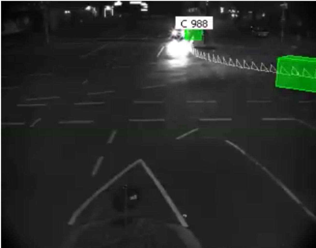
Abbildung 15: Das Fahrzeug C 988 wird nach der Hausdorff-Metrik als Anomalie klassifiziert, da für dieses Fahrzeug aufgrund einer fehlerhaften Positionsbestimmung eine Abweichung von der durchschnittlichen Trajektorie detektiert wurde.
