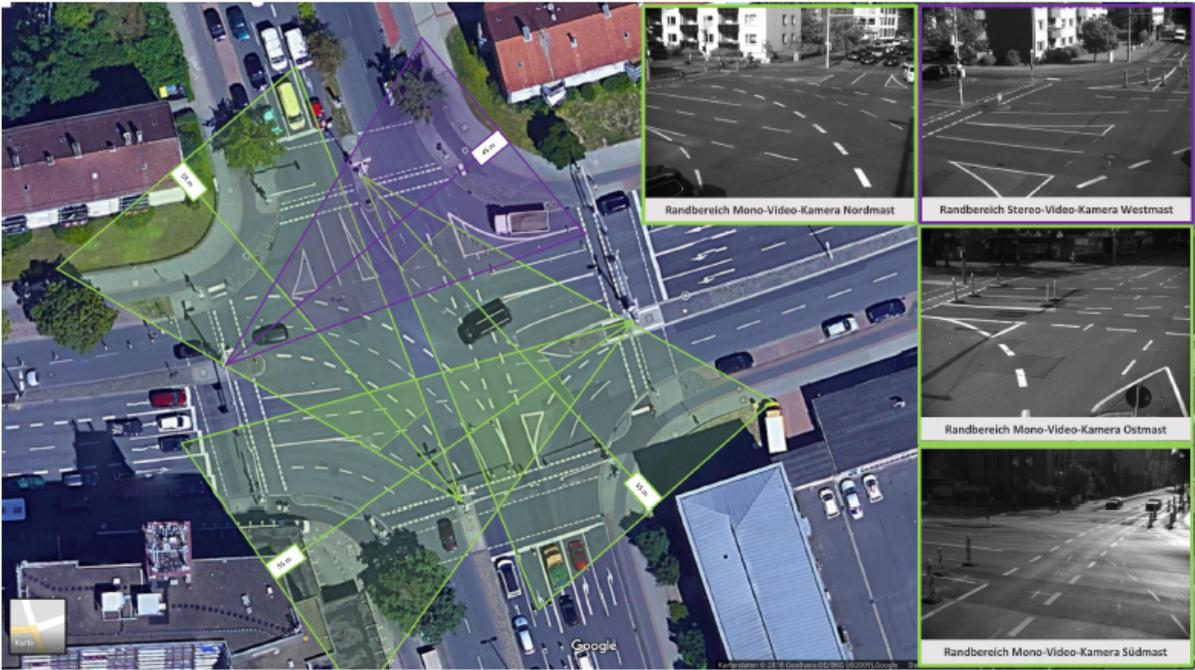
Abbildung 2: „Sichtbereiche der Sensor-Systeme zur 3D-Merkmalberechnung am Randbereich der Kreuzung.“ [Arn18, S. 98]
