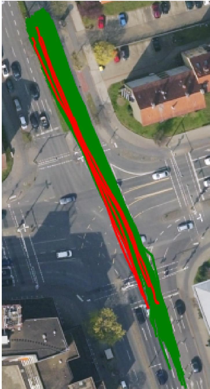
Abbildung 4.10: Trajektorien von Süden nach Norden. Grün: Trajektorien, die mit beiden Verfahren der Route zugeordnet werden. Rot: Trajektorien, die mit den beiden Verfahren unterschiedlichen Routen zugeordnet werden.
