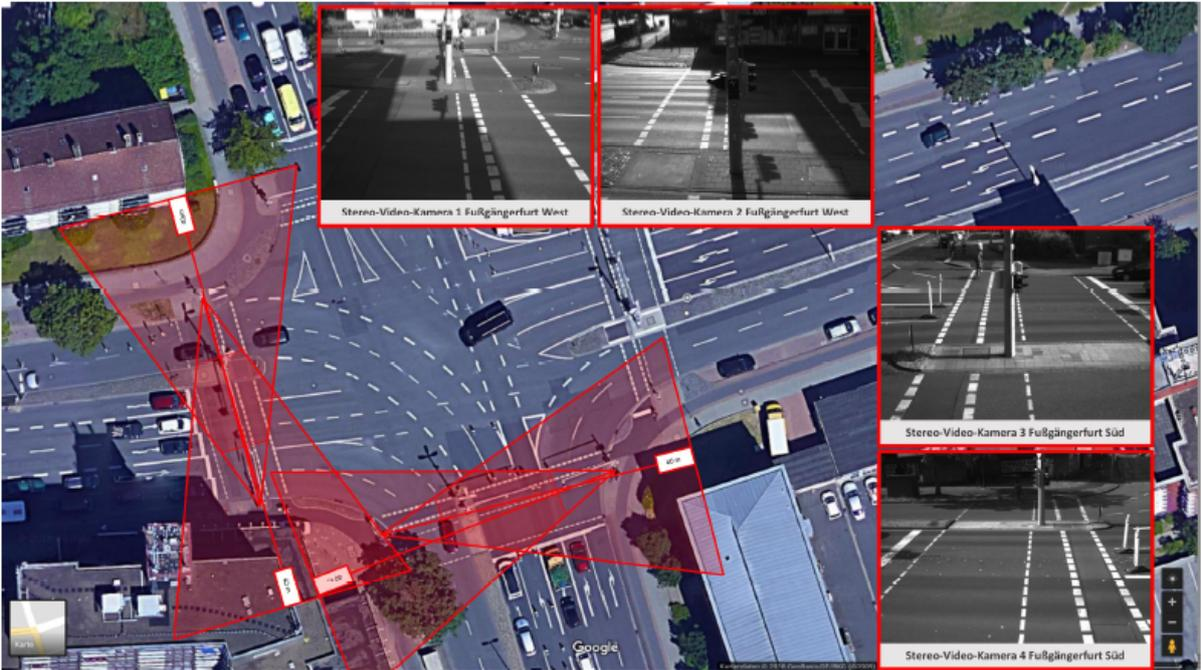
Abbildung 3: „Sichtbereiche der Stereo-Kameras zur Beobachtung der Fußgängerfurten im Westen und Süden der Kreuzung.“ [Arn18, S. 101]
