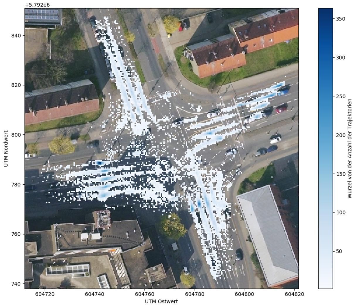
Abbildung 8: Verteilung der zuerst detektierten Position von Trajektorien
