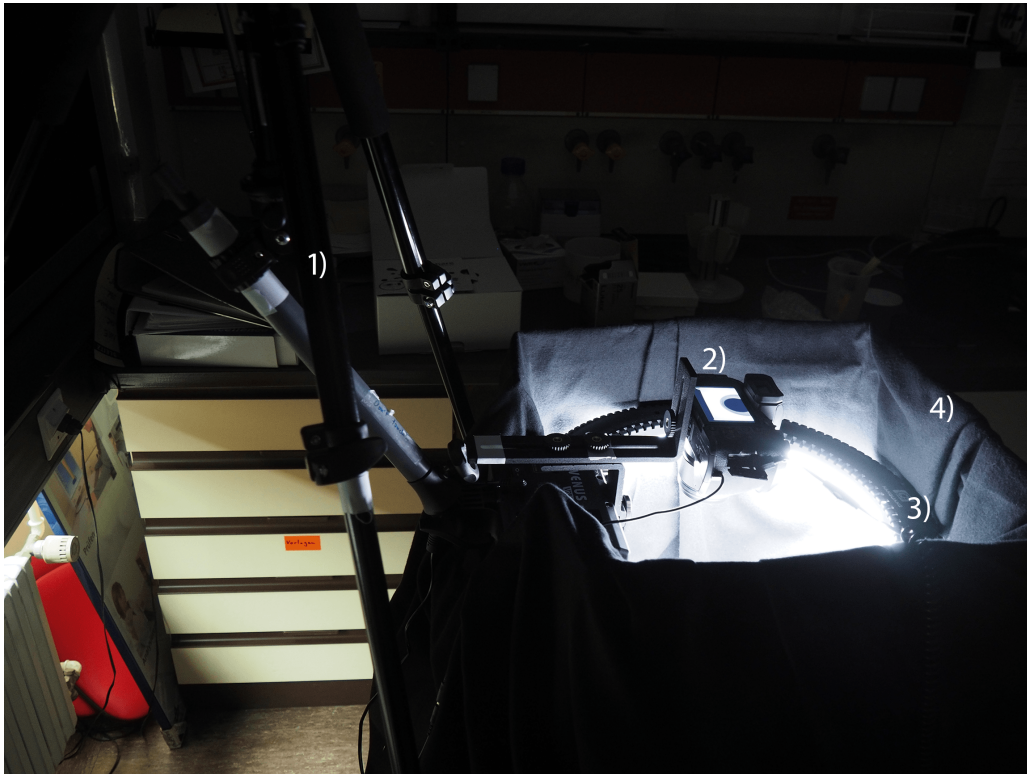
(a) Teststand: 1) Stativ, 2) Kamera, 3) Leuchtring, 4) abgedunkelte Box
