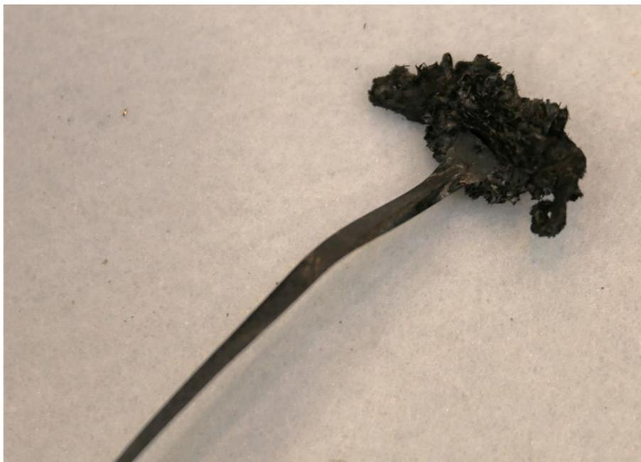
*Abbildung 9: Schadensbild eines im Legkopf feststeckenden Tows*
