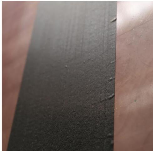
Abbildung 12: Beulen bei mit ATL abgelegtem Tape
