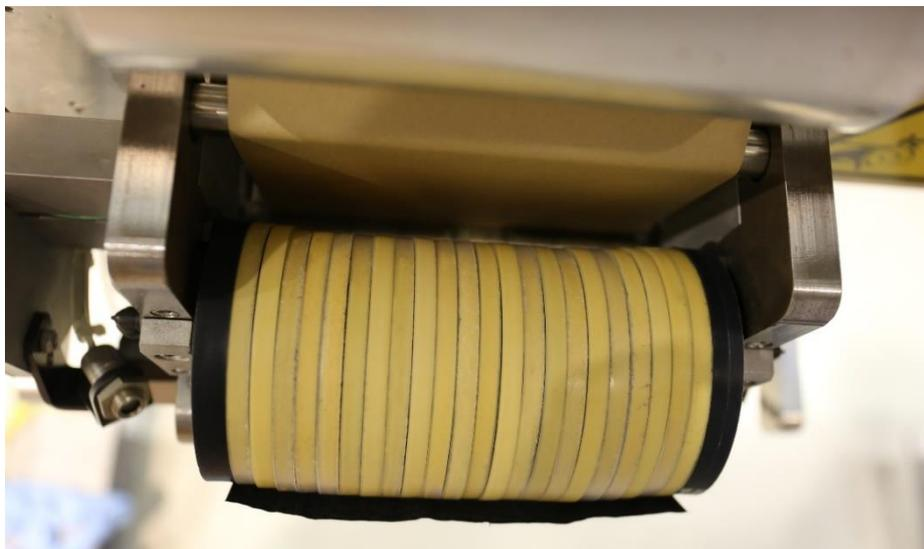
Abbildung 3: Segmentierte Kompaktierungsrolle
