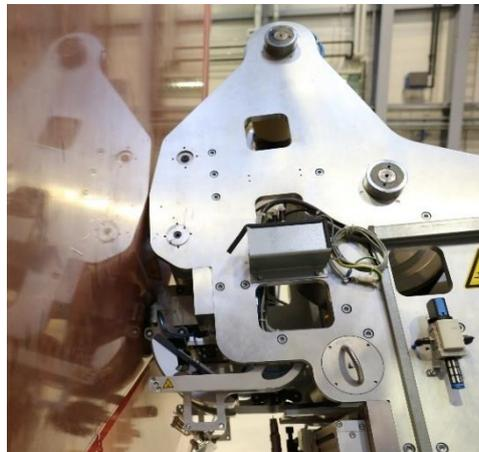
Abbildung 67: Kopf der ATL-Einheit beim Ablegen über Rampe
