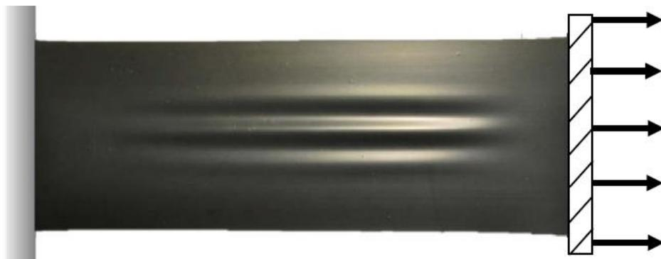
Abbildung 27: Längsfalten infolge Längszugspannungen (Quelle: [NAYY14])
