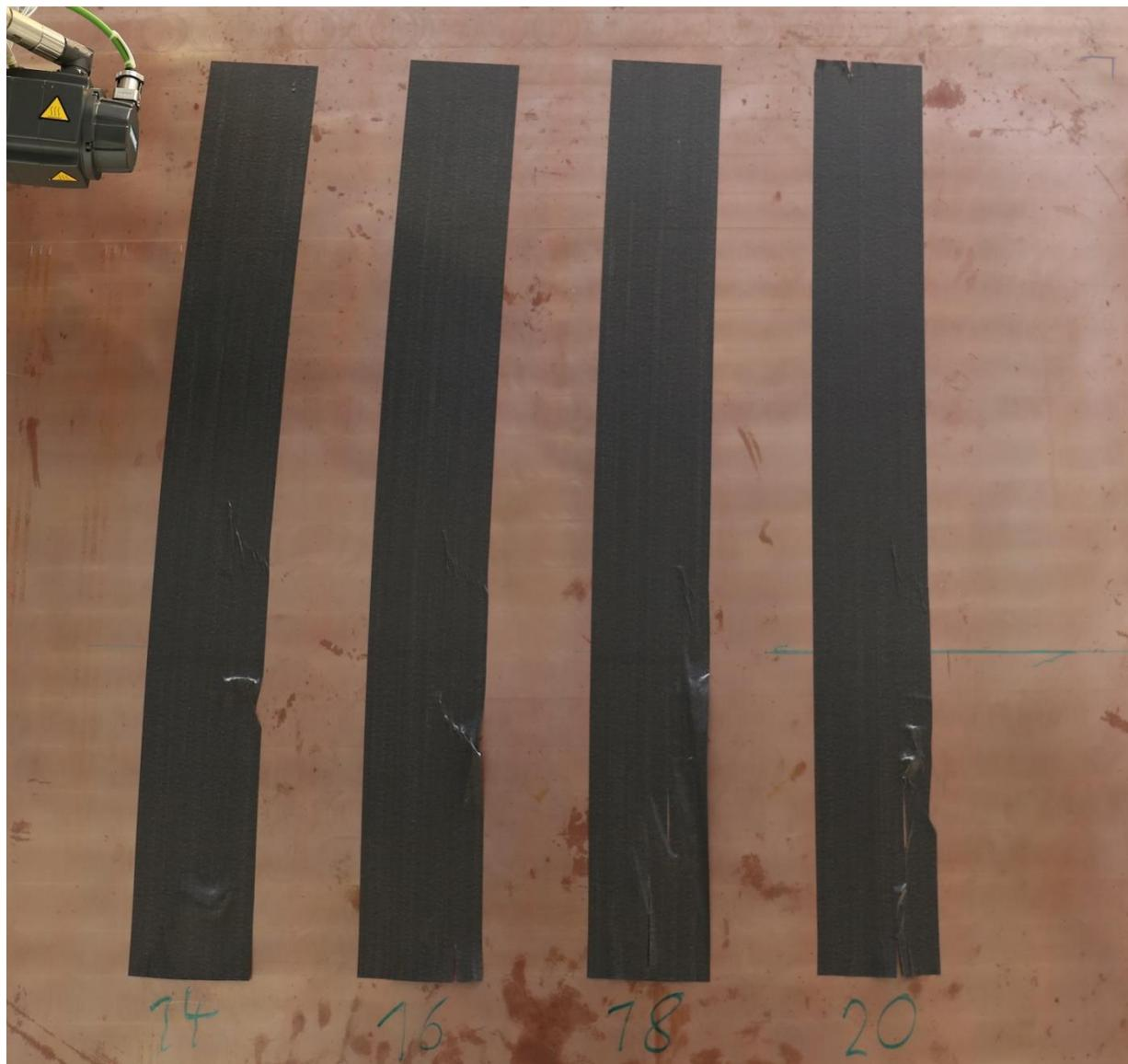
Steering-Versuch mit ATL; Radien  $R = 14$ ,  $R = 16$ ,  $R = 18$ ,  $R = 20$  (von links nach rechts); Versuchsdurchlauf 1
