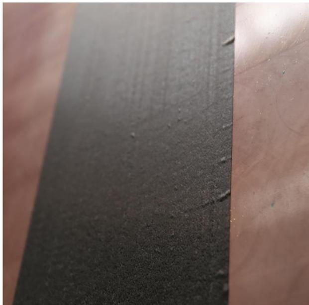
*Abbildung 49: Beulen beim Radius  $R = 16\text{ m}$*
