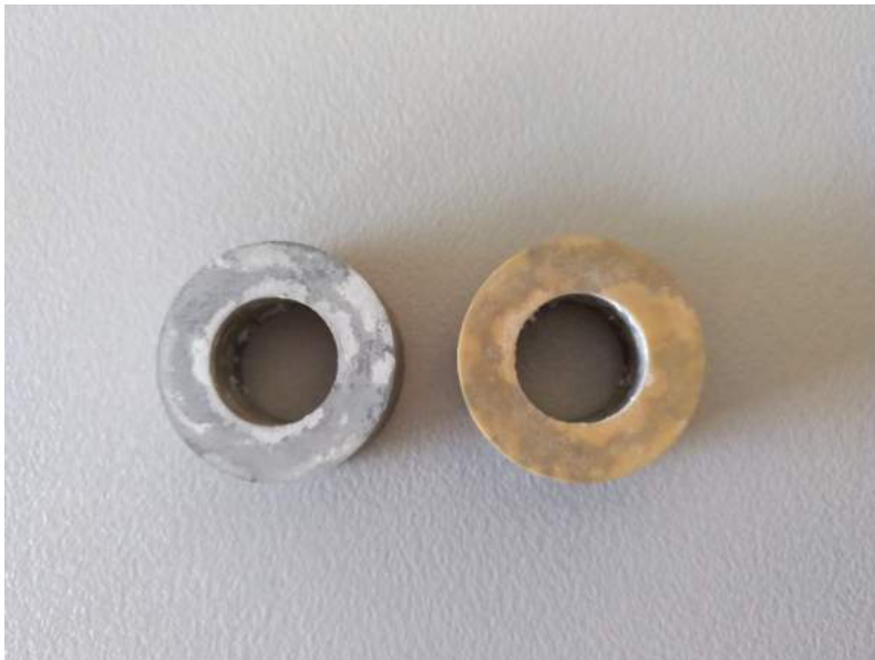
Abb. 3.17: Aluminiumoxid auf Trennflächen zerbrochener Proben
