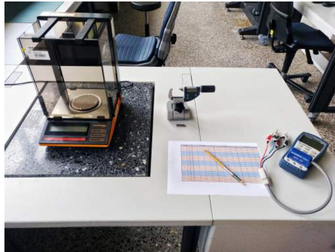
Abb. 3.11: Messplatz mit Feinwaage (l.), Bügelmessschraube (m.) und LCR-Meter (r.)
