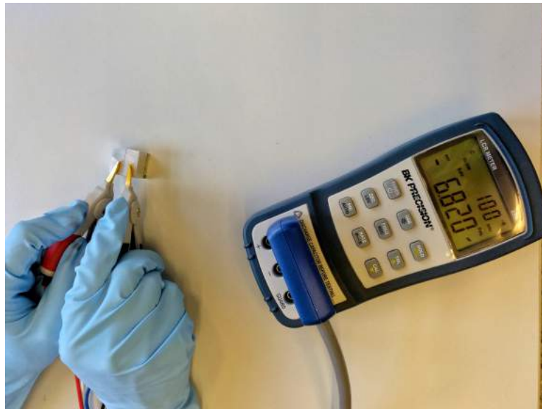
Abb. 4.7: Messen des CFK-Würfels
