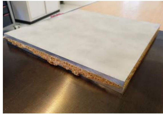
(b) Fertig verklebte Platten
