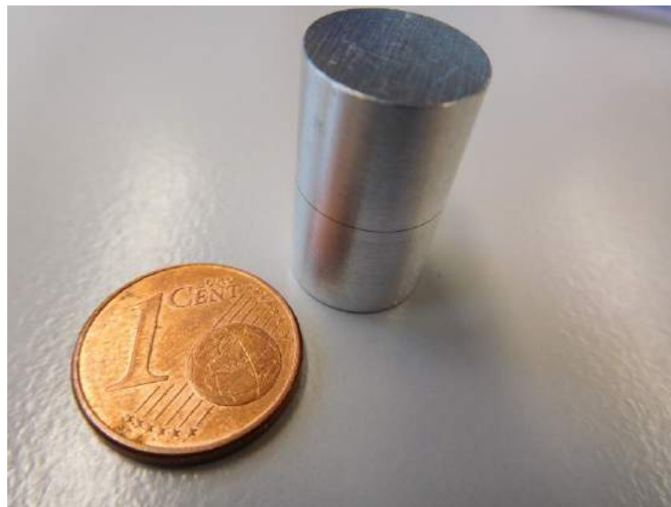
Abb. 2.3: Erster Entwurf des Feuchtigkeitsensors auf Basis von Kopfzugproben [1]
