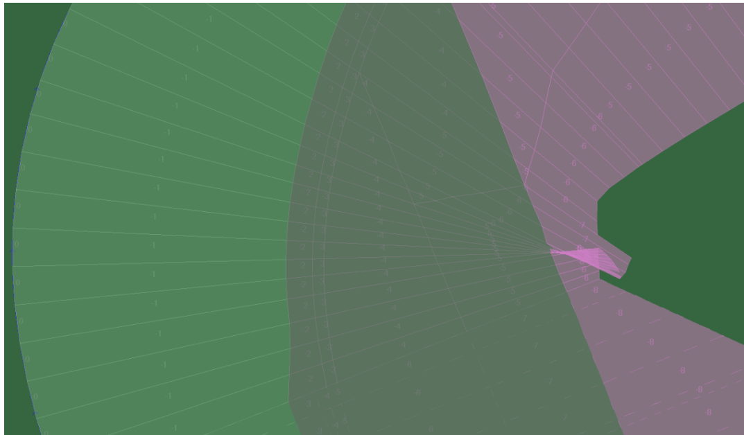
(a) Schematische Darstellung. Zu sehen sind die Referenzlinie (lilafarbene Pfeile unter lane zero ), ein Fahrstreifen (hellgrün, lane -1 vom Typ DRIVING) sowie weitere lanes der Typen BIKING, BORDER, SHOULDER (grau, lanes -2 bis -7 ) sowie SIDEWALK (pink, lanes -4 bis -8 )
