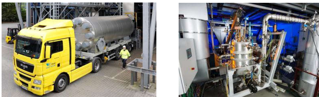
Abb.2-5 Thermochemische Speicher – links: Mobiler Energiespeicher basierend auf Sorption an Zeolithen, rechts: Laboranlage zur Speicherung von Hochtemperaturwärme basierend auf der Reaktion von Kalk mit Wasserdampf
