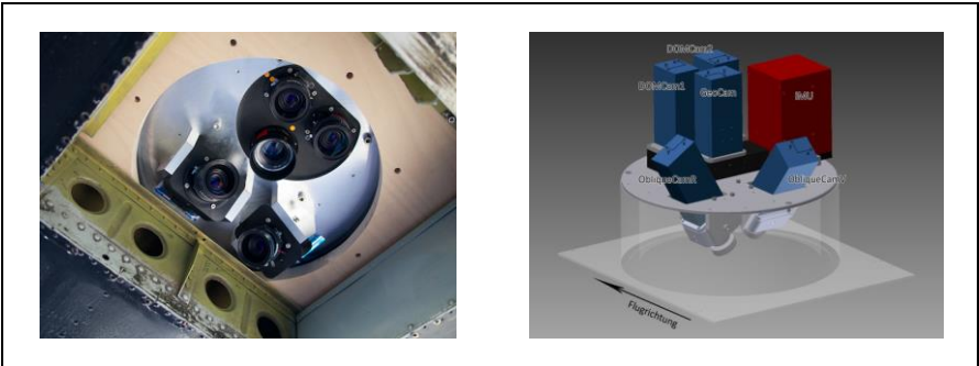
Abb. 2. Aufbau des MACS-Oblique.
