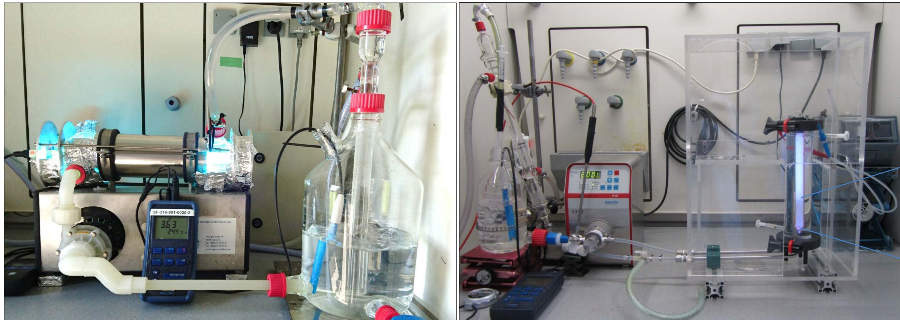
Abbildung 1: Versuchsaufbau zum Abbau von Antibiotika (hier: Sulfamethoxazol). Links klassischer UVC Strahler, rechts Phosphor-konvertierten Xenon-Entladungslampen.
