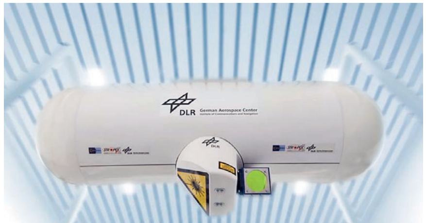
Experimentelles optisches Kommunikationsterminal für die Stratosphäre, geflogen im Projekt CAPANINA 2005
