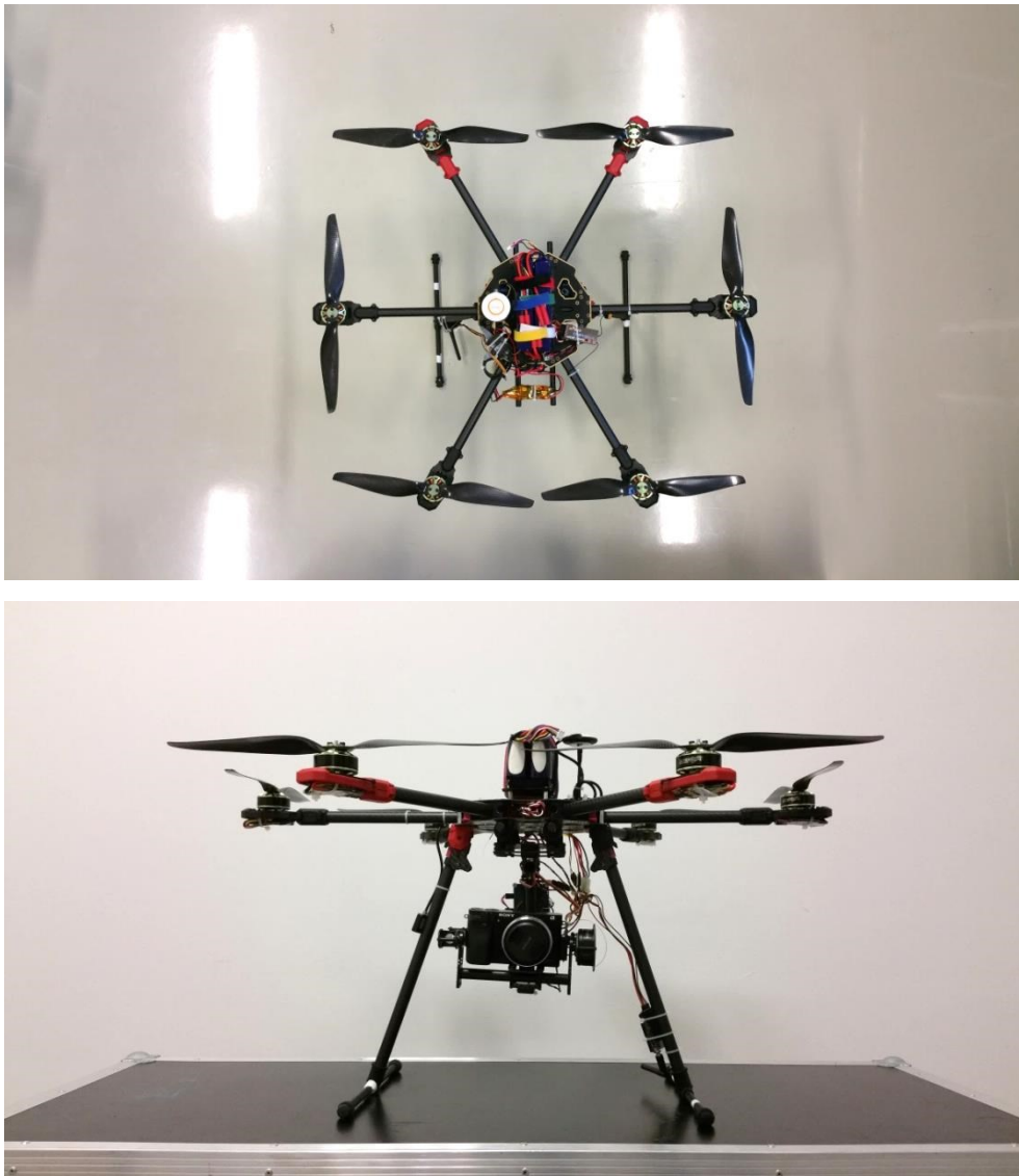
Abb. 3: Der Hexakopter des Lehrstuhls für Bergbaukunde wurde an die zuvor definierte Kamera angepasst und alle weiteren Komponenten auf die zu tragende Dienstmasse ausgelegt.
