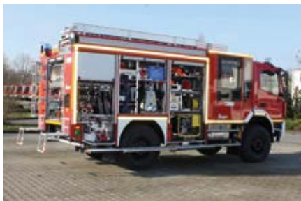
Löschgruppenfahrzeug LF KatS auf Mercedes-Benz Atego-Allradfahrgestell. (Foto: BBK)
