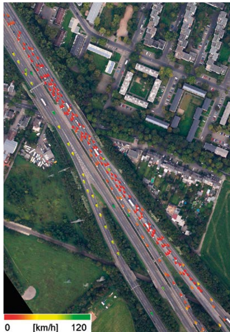
Abb.1: Luftgestützte Erfassung von Fahrzeugen und deren Momentangeschwindigkeit auf einer Bundesautobahn.
