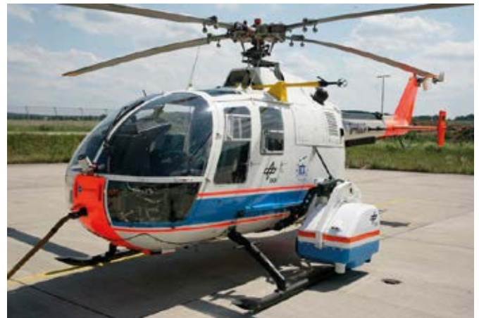
Abb. 3: Der DLR-Hubschrauber Bo-105 mit dem optischen 4k-Sensor.
