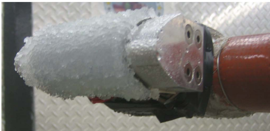
Abbildung 3: Vereister Dummy einer Profilnase [7]
