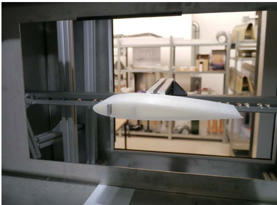
Abbildung 7: Zweite Version des Profils im Windkanal (Eisfrei)
