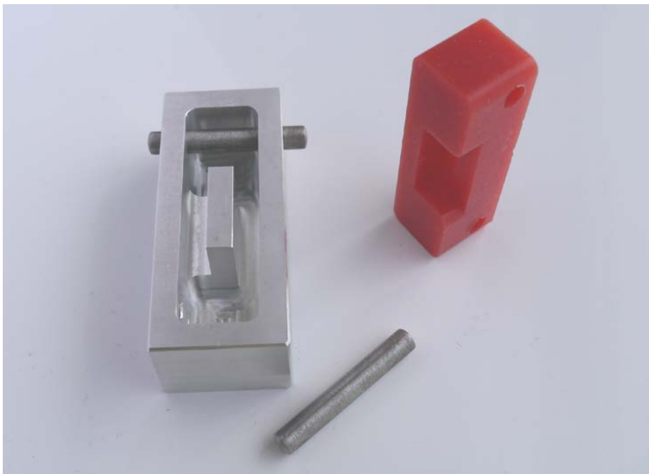
Abbildung 14: Aluminiumnegativform und Silikonform
