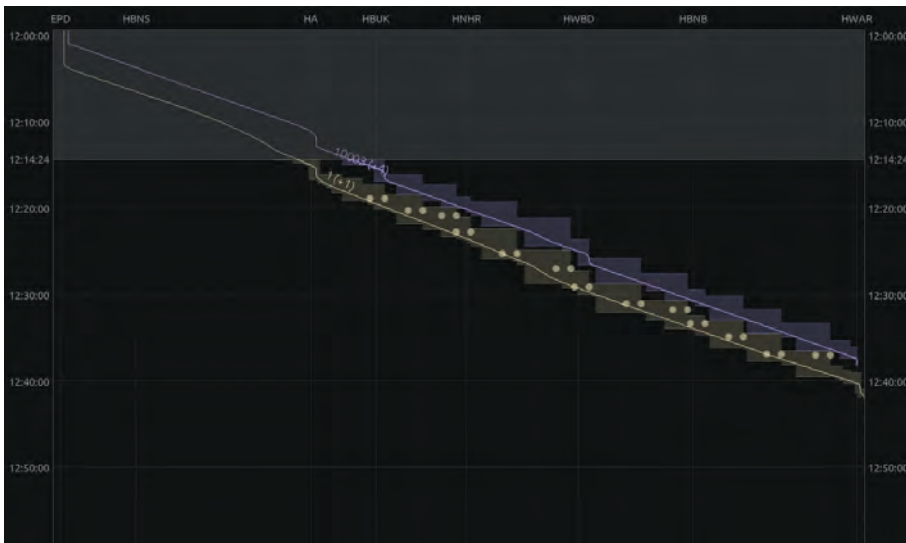
Abb. 3: Screenshot des OVM-Tools: Zwei Züge fahren von Paderborn nach Warburg (Westf.), die Punkte entsprechen den Zielpunkten für den zweiten Zug, die nicht vorher früher werden dürfen.
