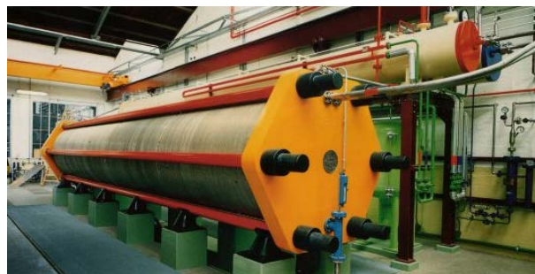
Abbildung 1-14: Druckelektrolyseur nach dem System LURGI [ELT 2, 2014]
