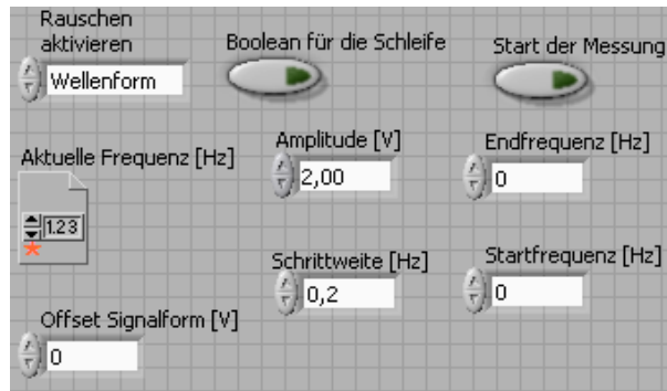
Abbildung 7.40.: Sub-VI zur Kontrolle der gewählten Einstellungen (Frontpanel), Autor: René Pfeifer
