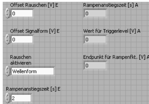
Abbildung 7.42.: Sub-VI zur Bestimmung der Rampenzeit sowie den Werten für das Triggerlevel und Endpunkt der Rampe (Frontpanel), Autor: René Pfeifer
