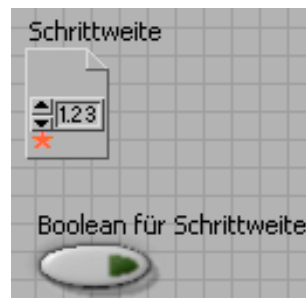
Abbildung 7.46.: Sub-VI zum Ein- oder Ausblenden des Bedienelements „Schrittweite“ (Frontpanel), Autor: René Pfeifer
