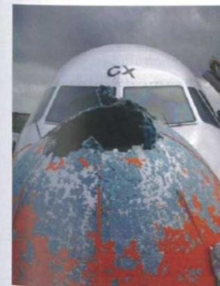
Abb. 16-6: Hagelschaden am Radom des Airbus A319, der am 1. Oktober 2009 auf dem Flug von Forli nach Palermo in eine Hagelzelle geraten war (Foto: ATRDRIVER).
