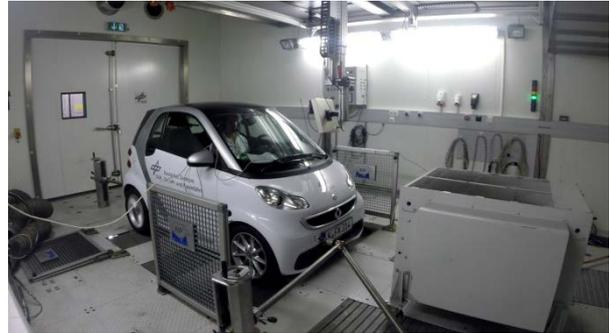
**Bild 3:** Demonstratorfahrzeug auf dem Rollenprüfstand.
