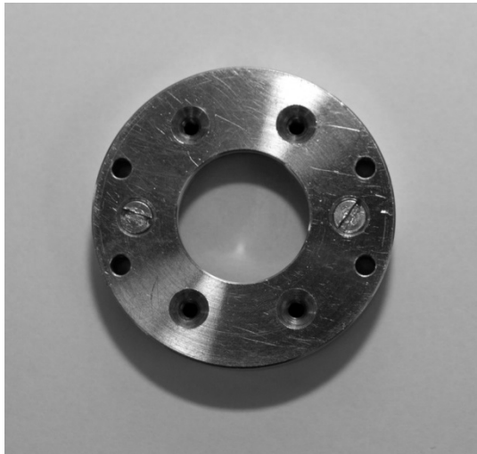
Abbildung 6: Beobachtungskammer mit einem Durchmesser von 22mm und einer Schichtdicke des Versuchsraums von 1mm bzw. 0,6mm .
