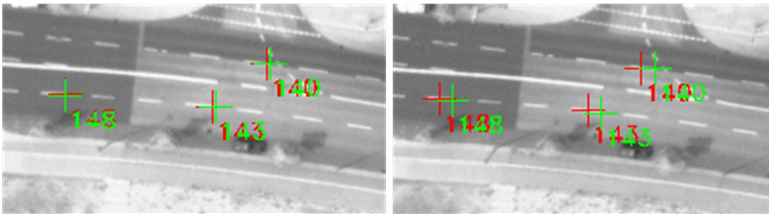
Abbildung 4.4: Passpunkte in GeoTIFF-Bildern, grün - wahre Position, rot - projizierte Position, links - RMS = 1,6 Pixel (30 cm), rechts - RMS = 7,5 Pixel (150 cm)
