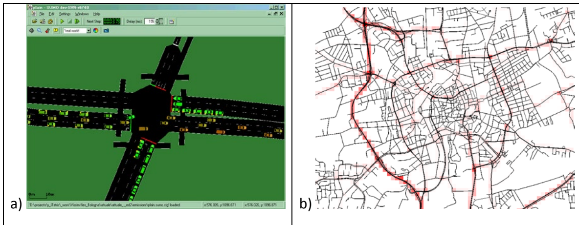
Abbildung 2: a) Darstellung der aktuellen CO 2 -Emissionen simulierter Fahrzeuge; b) Darstellung des simulierten CO 2 -Ausstoßes in Braunschweiger Innenstadt, normaler Wochentag, 6:00 bis 7:00, Aggregation in Flächen von 100 m x 100 m
