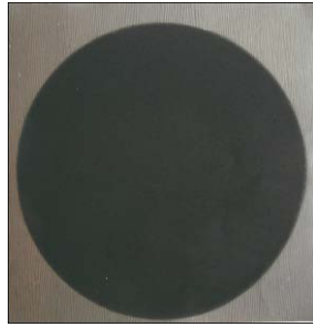
Abbildung 7: Beschichtete Kathode auf Showa Denko Substrat
