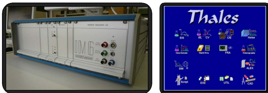
Abbildung 13: IM6-Potentiostat mit der THALES Bedienungsfläche
