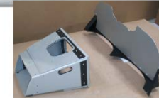
Crashbox, Schottwand und Unterboden aus Metawell Platten
