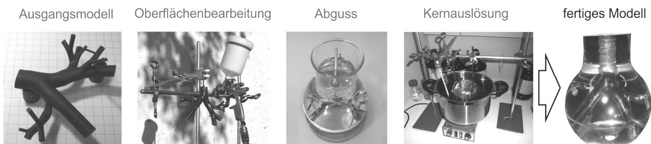
Bild 7 Schematische Darstellung der Arbeitsschritte zur Fertigung eines hochtransparenten Gussmodells.
