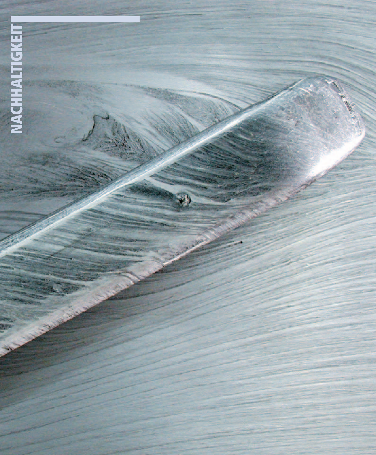
Abb.: Sichtbarmachung der „Wandstromlinien“ eines Hochgeschwindigkeitszugs bei Seitenwind mittels Ölanstrichtechnik.
