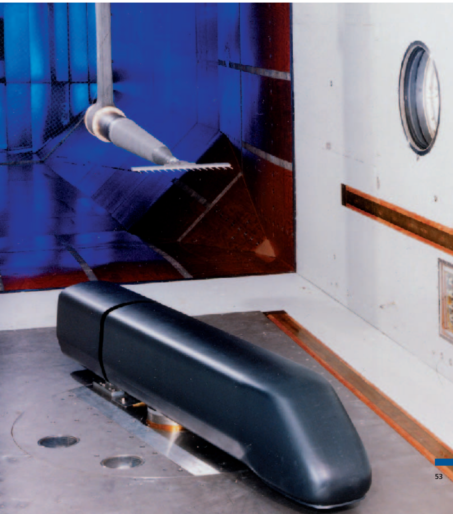
Abb. unten: Hochgeschwindigkeitszugmodell in der Messstrecke des kryogenen Windkanals (KKK) des DNW in Köln. Abb. links: Schallquellenanalyse an einem Serienfahrzeug.
