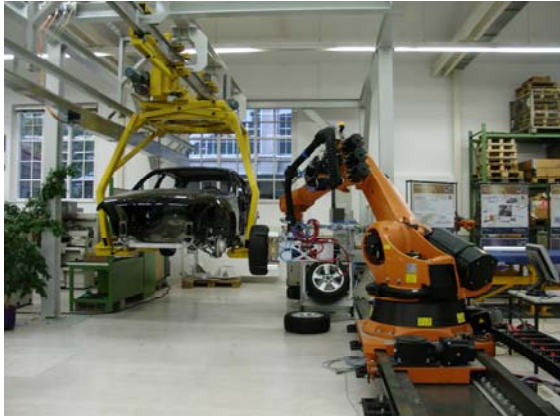
Bild 1: links: Gesamtansicht mit einem auf einer Linearachse montierten KUKA-Roboter und einer durch eine Elektrohängebahn transportierten Karosse; rechts: Detailansicht des Endeffektors mit nachgiebigem Kraft-Momentensensor
