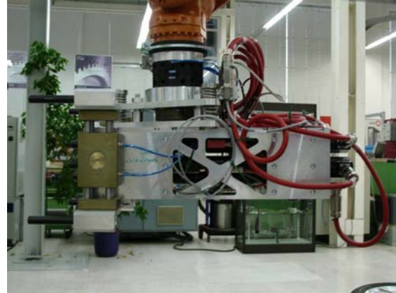
Bild 1: links: Gesamtansicht mit einem auf einer Linearachse montierten KUKA-Roboter und einer durch eine Elektrohängebahn transportierten Karosse; rechts: Detailansicht des Endeffektors mit nachgiebigem Kraft-Momentensensor
