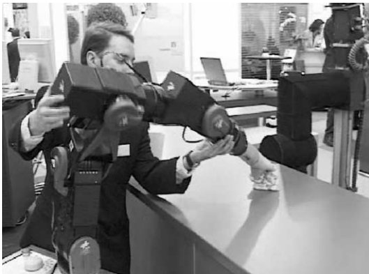
Bild 8 LBR II wischt einen Tisch ab und weicht gleichzeitig den Berührungen des Menschen aus (Nullraumbewegung des Ellbogens).
