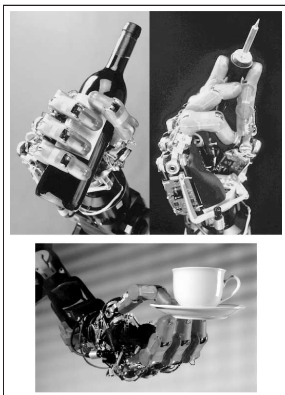
Bild 16 Reale Kraftgriffe (oben) und Fingerspitzengriffe (rechts und unten).
