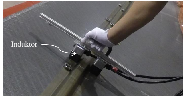
Abbildung 6: Induktive Stringerheftung bei Demonstratorfertigung
