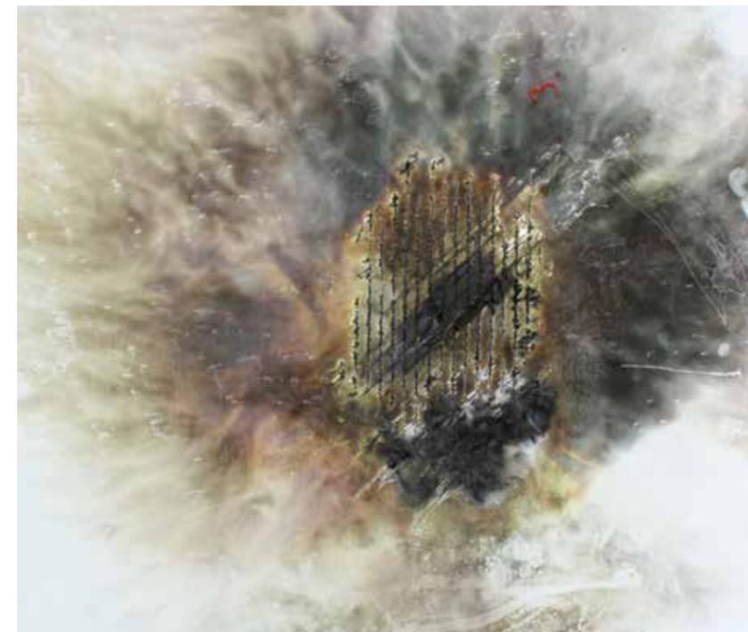
Lackierte Versuchsplatte nach Blitzschlagversuch
