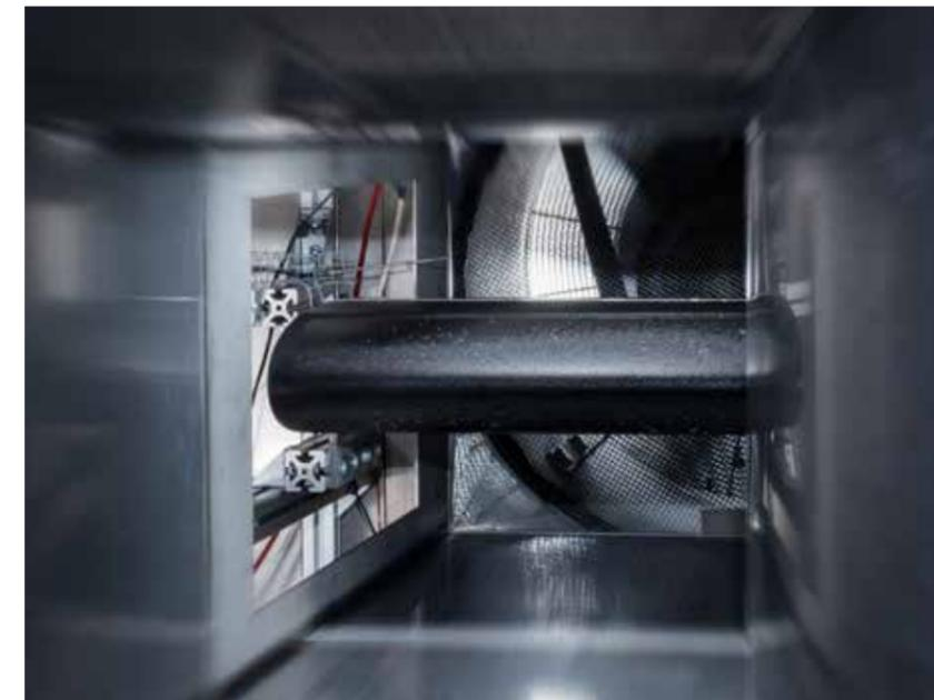
Detektor zur Erkennung des Vereisungsprozesses über die Wärmebilanz. Der Detektor kann bündig montiert werden.
