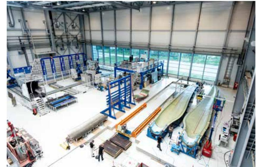
Die Forschung am ZLP-Standort Stade konzentriert sich auf die Herstellung von komplexen Bauteilen in hochproduktiven Faserablage-Verfahren, die Steuerung von thermischen Aushärteprozessen und die voll automatisierte Fertigung von Großserienbauteilen im RTM-Prozess
