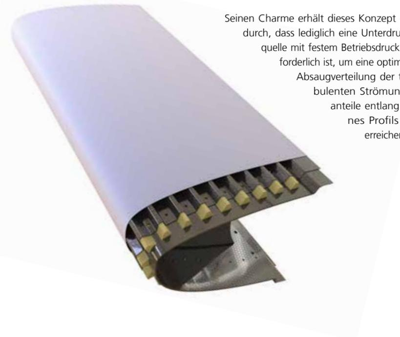
Multifunktionales Strukturkonzept der Vorderkante: erosionsschützende Außenhaut, aerodynamische Luftkanäle mit Drosselöffnungen und lasttragende Struktur mit Rippen
