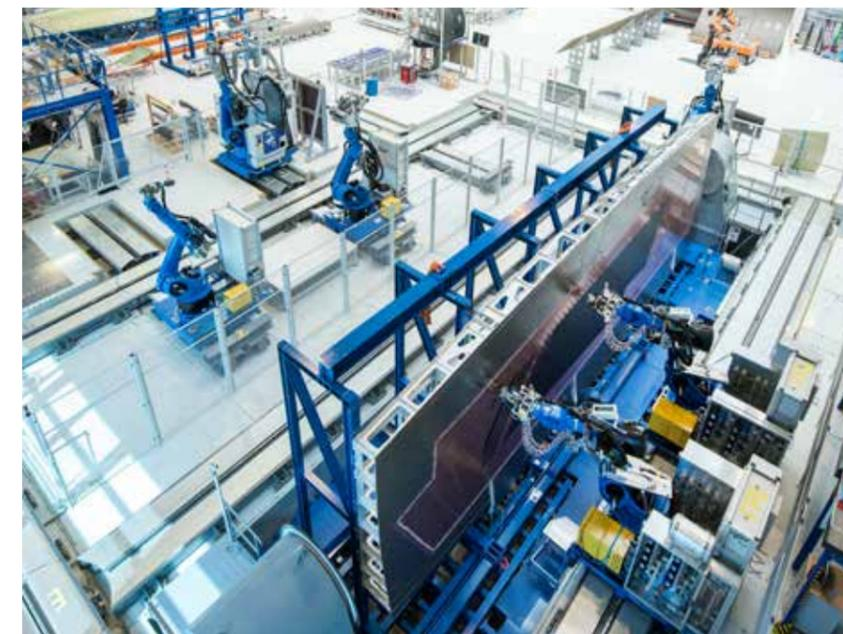
Online-Messung der Faserorientierung in mehrlagigen textilen Preforms mittels Wirbelstromsensoren
