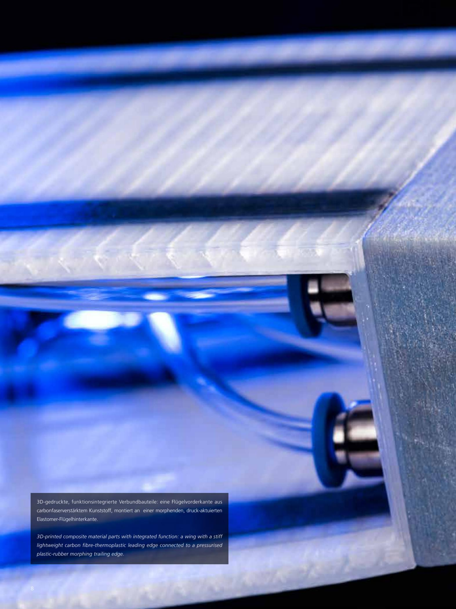
3D-gedruckte, funktionsintegrierte Verbundbauteile: eine Flügelvorderkante aus carbonfaserverstärktem Kunststoff, montiert an einer morphenden, druck-aktuierten Elastomer-Flügelhinterkante.
