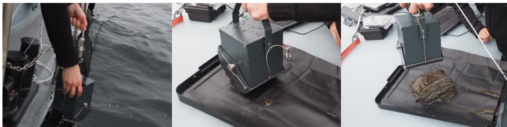
Abbildung 6: Entnahme von Bodenproben mit dem Ekman-Birge-Greifer
