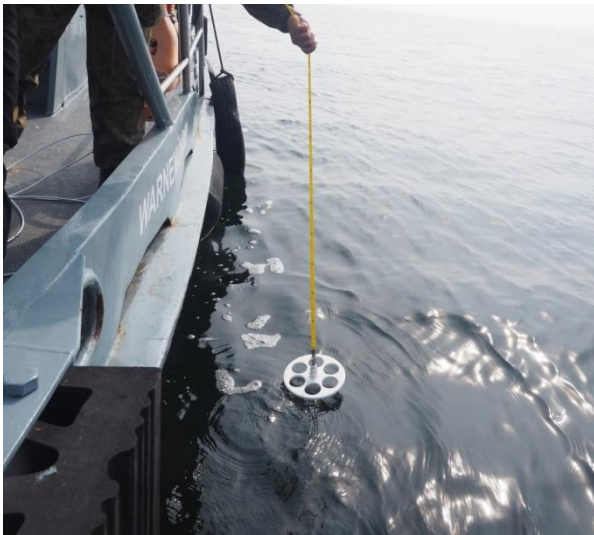
Abbildung 5: Messung der Sichttiefe mit der Secchi-Scheibe
