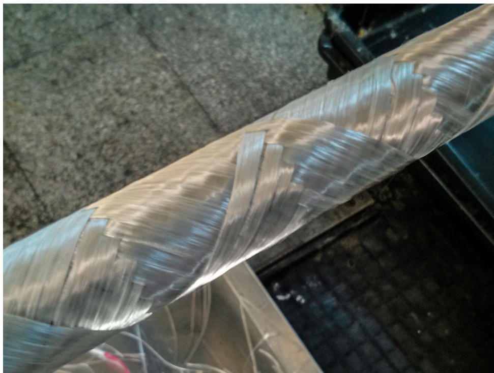
Abbildung 5: Trocken gewickelte Rovings in \pm 45^\circ -Richtung mit einem Fadengewicht von 2400tex
