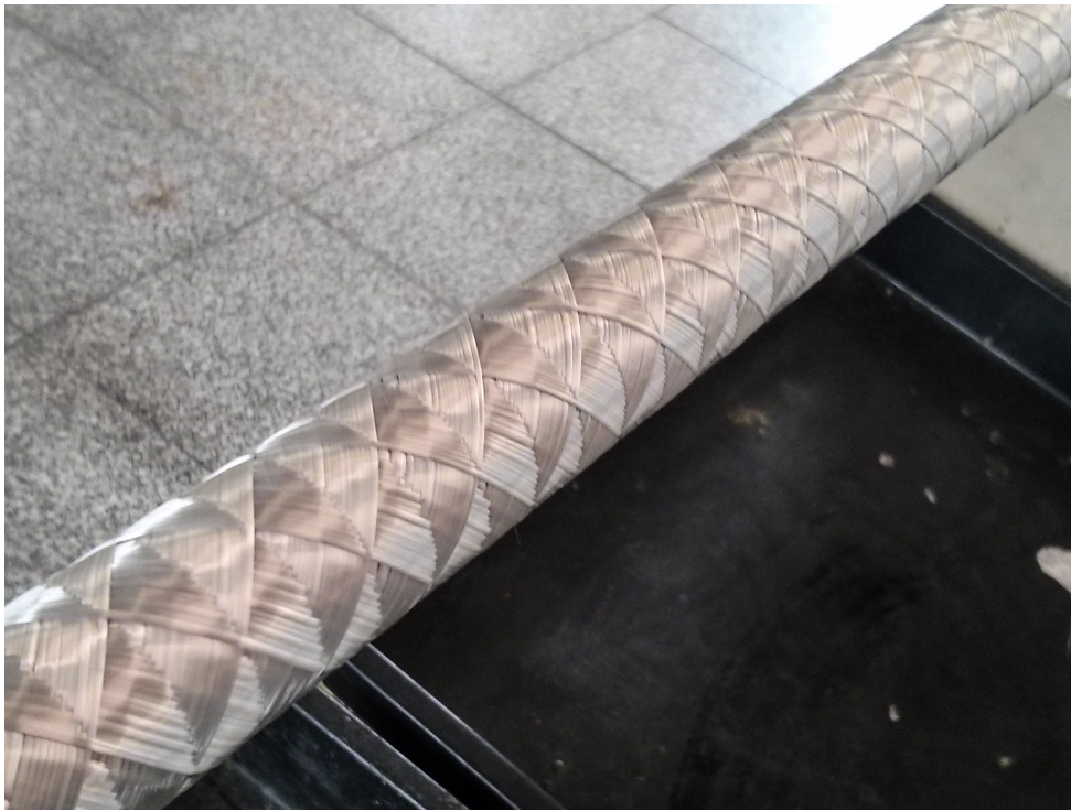
Abbildung 78: Trocken gewickelte feine Rovings mit einer Stärke von 300tex.
