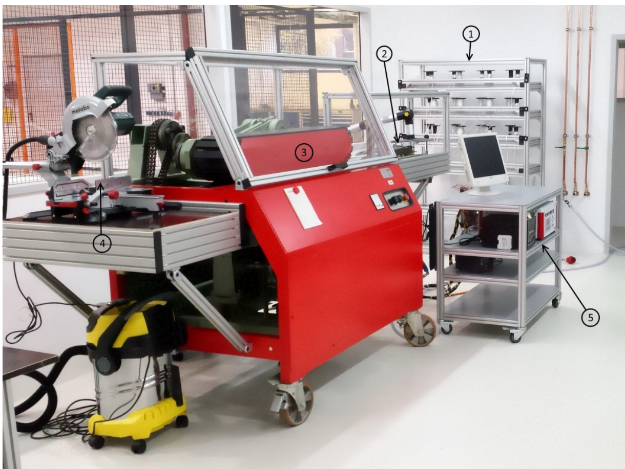
Abbildung 75: Pultrusionsanlage im Labor mit: (1) Faserlager, (2) Injektion und Formwerkzeug, (3) Raupenabzug, (4) Kappsäge, (5) Steuer-PC und Leistungsverstärker
