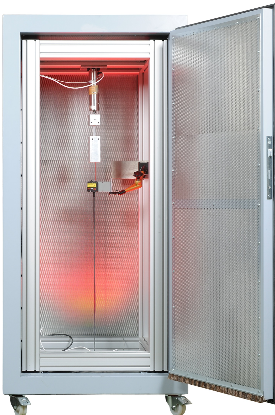
Abbildung 69: VHCF-Prüfstand in schallisolierender Kammer
