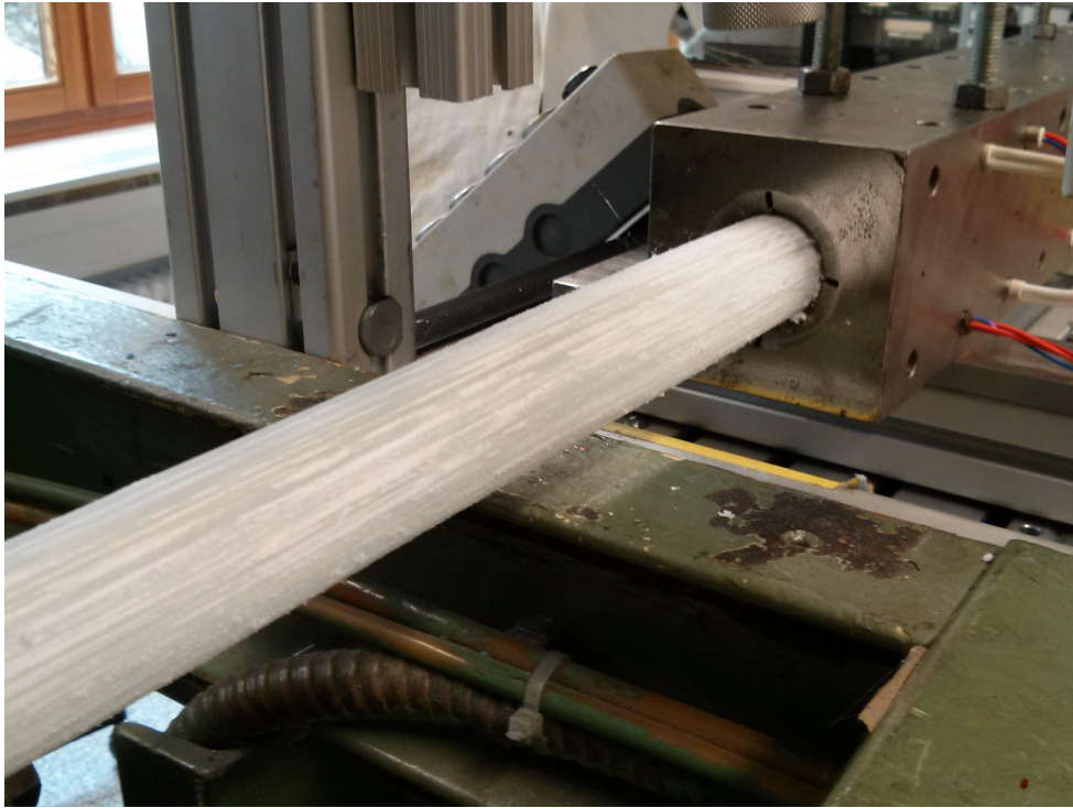
Abbildung 76: Abzug eines pultrudierten Rohres aus dem Formwerkzeug
