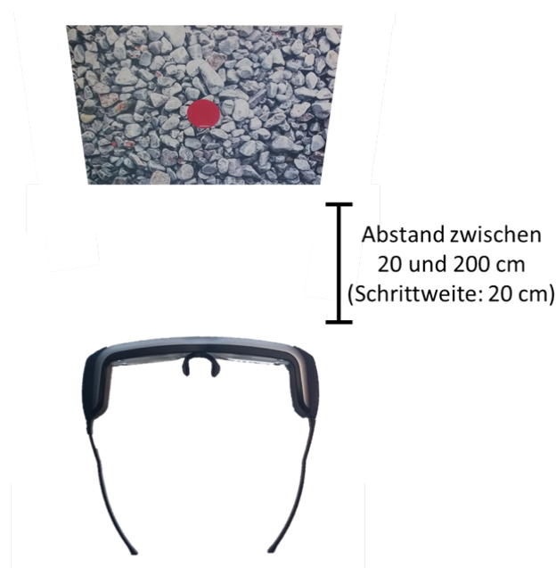
Abbildung 5.10: Messaufbau der Jittermessung
