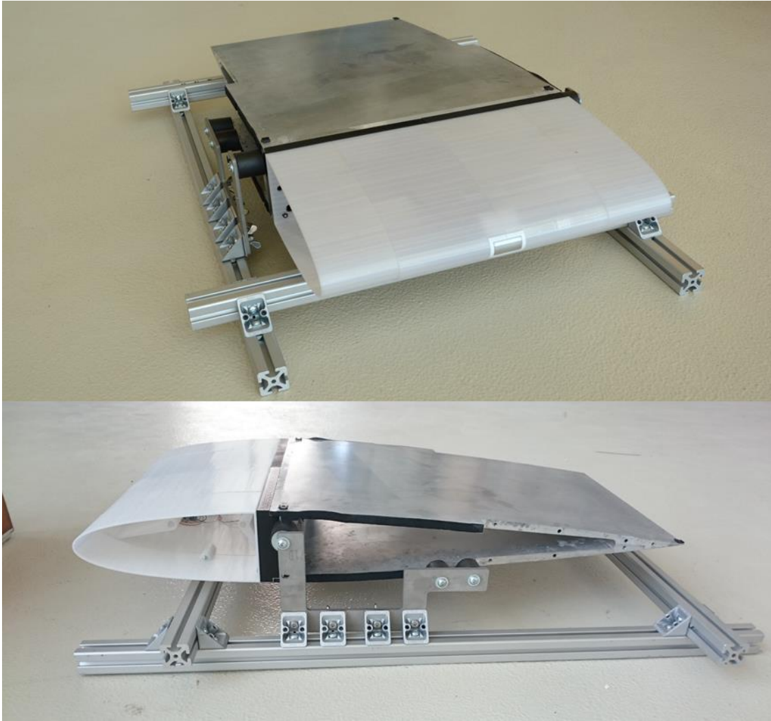
Abbildung 67: Bilder der an der Hinterkante montierten Flügelvorderkante mit Adapter; Ansicht von vorne (oben) und von der Seite (unten)
