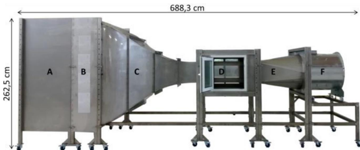
Abbildung 47: Schematische Darstellung des Windkanals
