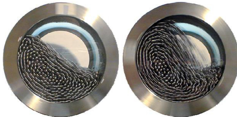
Bild 3-2 Kaskadenwirkung (links) und Kateraktwirkung (rechts) in einer Trommelmühle [12]
