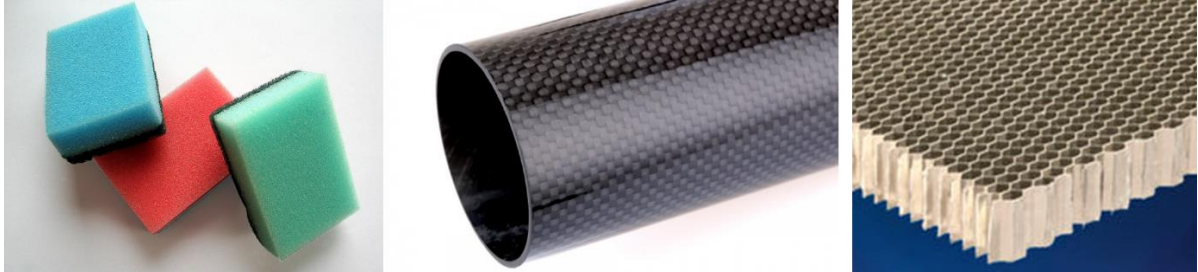
Abbildung 4.2: Beispiele von Materialien, die in der Crashstruktur eingesetzt werden können; von links nach rechts: Schaumstoffe, CFK-Rohr und Aluminium Honigwaben
