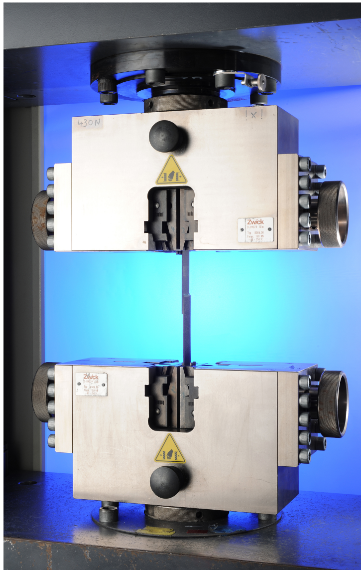
Abbildung 3.1: Skizze des Keil-Schraub-Probenhalters für Zugversuche
