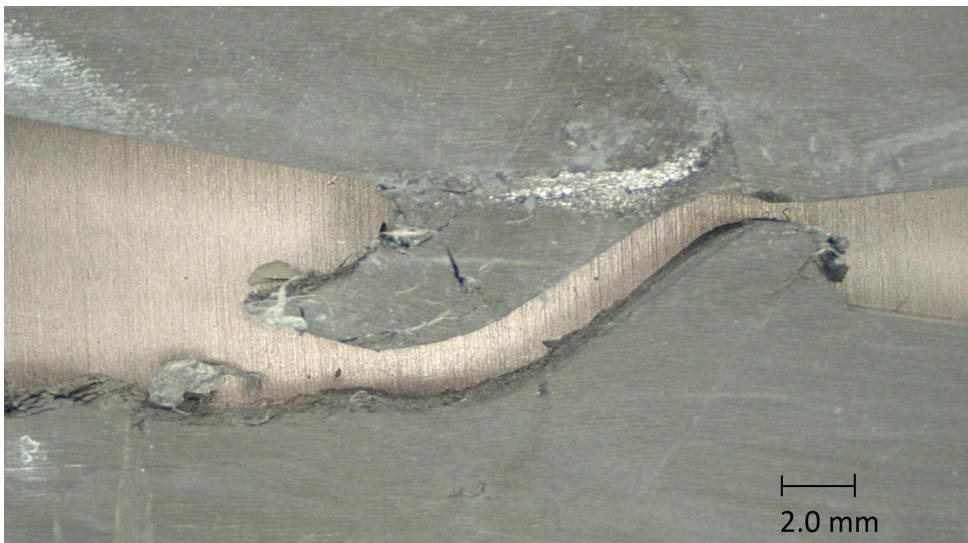
Abbildung A.8: Bruchbild Totalversagen \varphi = 30^\circ \perp\perp -Materialorientierung
