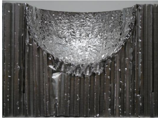
Abbildung 2.16: Schnittbild einer Honigwabenstruktur nach einem senkrechten Impact
