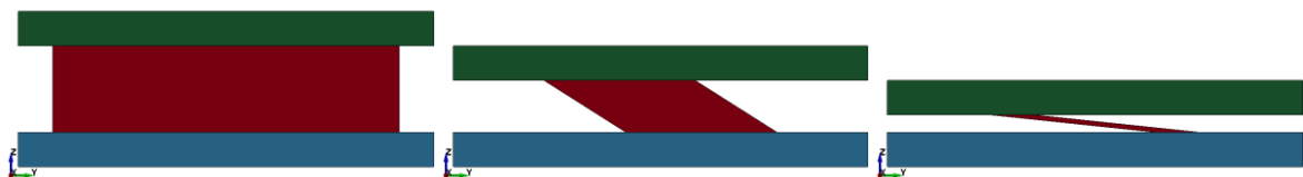
Abbildung 4.17: Verformung eines einzelnen Honigwabenelementes unter Druckbelastung in Z-Richtung bei einer Drehung der Materialrichtung um die W-Achse
