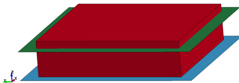
Abbildung 4.8: Durchdringung zwischen dem Volumen- und dem Schalenelement während der Drucktestsimulation in Z-Richtung der Simulation
