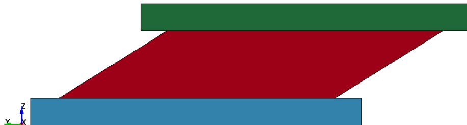
Abbildung 4.26: Verformung eines einzelnen Honigwabenelementes unter Schubbelastung
